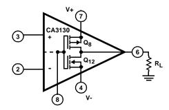
FIGURE 6A. DUAL POWER SUPPLY OPERATION
