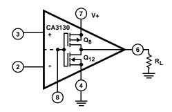
FIGURE 6B. SINGLE POWER SUPPLY OPERATION
