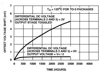
FIGURE 5. TYPICAL INCREMENTAL OFFSET-VOLTAGE SHIFT vs OPERATING LIFE
